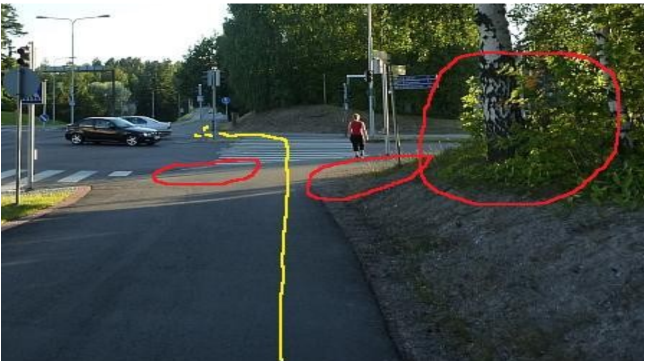
Reittikuva 25. Keskussairaalantien ja Rautpohjankadun risteys. Ajolinja laatuikäytäväreittiä pitkin on merkitty keltaisella – risteuksen jälkeen pitää tehdä melko jyrkkä käänös. Vaarallinen reunakiveys, hiekkainen alue ja näkemäongelma on ympyröity punaisella.
