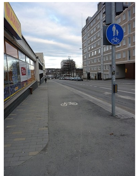
Reittikuva 10. Cygnaeuksenkadun kevytväylä näyttää erotellulta, ja katumerkintäkin tukee tätä, mutta liikennemerkkin mukaan väylä on yhdistetty.
