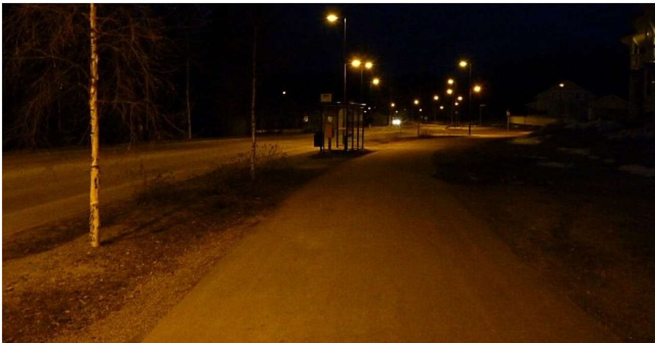
Reittikuva 70. Kevytväylällä on oma valaistus, mutta silti viereinen ajorata on tasaisemmin valaistu – ilmeisesti käytetty valaisinmalli on suunniteltu lähinnä autoteille eli asennettavaksi korkeammalle. Valaistus on kuitenkin sinänsä riittävä.
