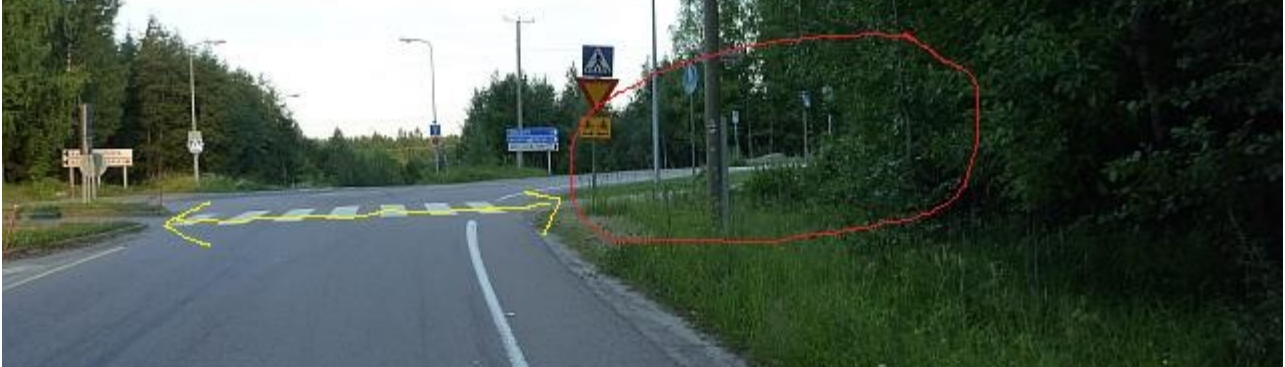
Reittikuva 40. Näkymä valtatie 23:n liittymärampilta laatukäytävälle. Autoilijoilla on oikeaoppisesti kolmio ja varoitusmerkki pyöräilijöistä. Näkemä oikealle Ronsuntaipaleentien suuntaan ei ole riittävä.
