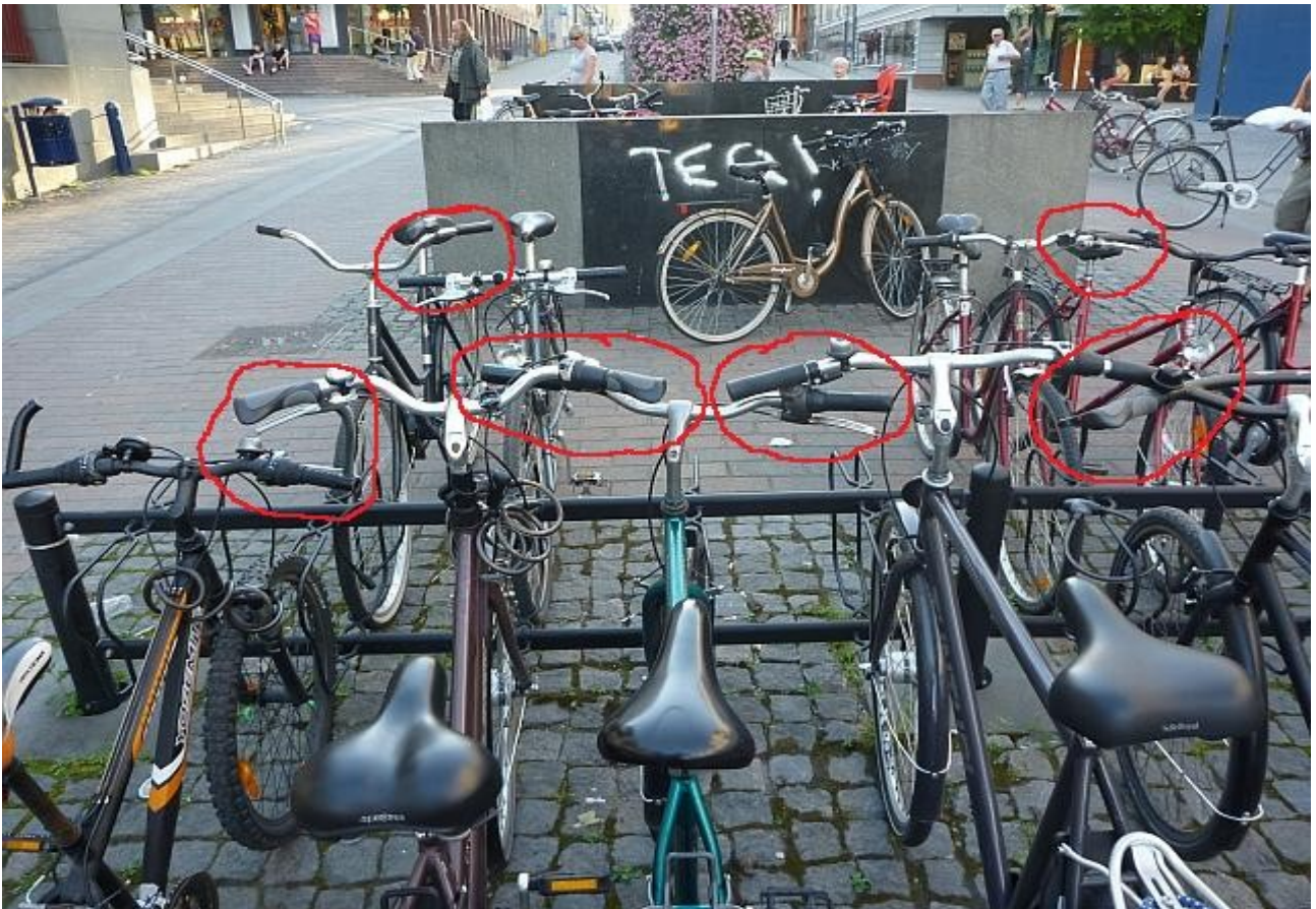
Reittikuva 3. Yksi Kompassin ympäristön pyörätelineistä rauhalliseen ilta-aikaan. Punaiset ympyrät osoittavat kohtia, joissa pyörien tangot ovat haitallisesti lomittain. Käytännössä näistä telineistä vain joka toisen pyöräpaikan pitäisi olla yhtä aikaa käytössä.
