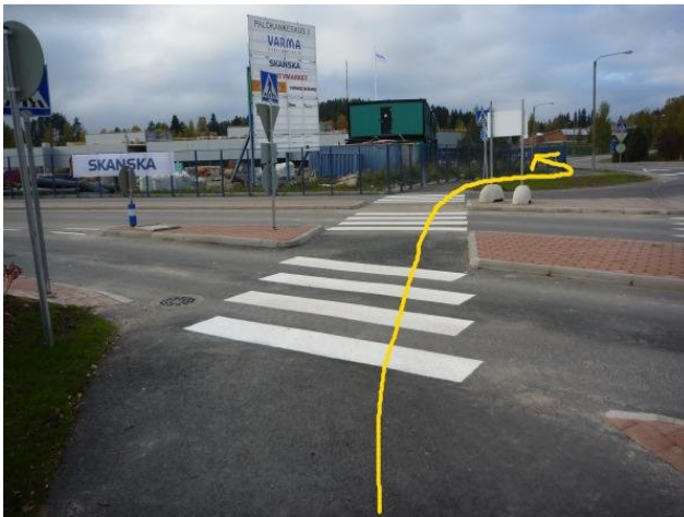
Reittikuva 27. Sammontien liikenneympyrän vieressä risteys on esimerkillisen tasainen. Ajolinja mutkittelee hankalasti erityisesti suojatien jälkeen.
