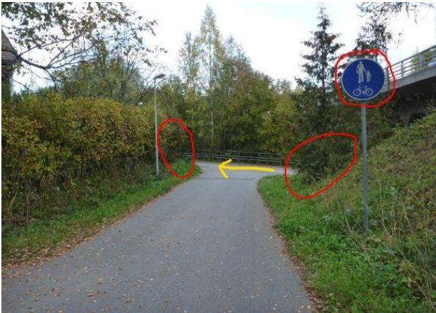
Reittikuva 50. Lohikoskentien alittavan tunnelin edustan risteys Lohikoskentien kevytväylältä nähtynä. Kulmissa on näkemäongelmat, ja kevytväylämerkki on sijoitettu aivan Lahkomylynpolun viereen.
