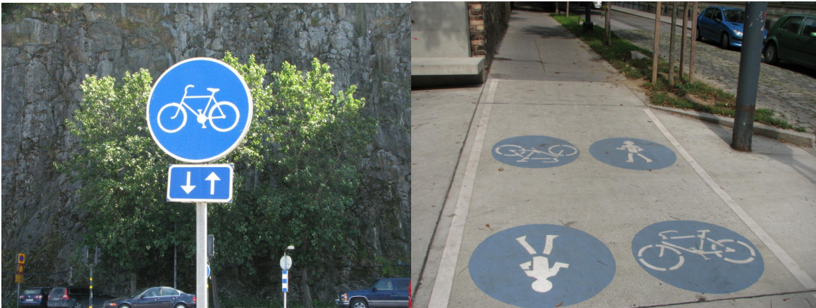
Vasemmalla kaksisuuntaisen pyörätien merkintä Tukholmasta. Oikealla yhdistetyn jalankulku- ja pyöräilyväylän maalauksia Wienistä - nuolimerkintöjä ei tarvita ja sekä pyöräily että jalankulku on katumaalauksin ohjeistettu oikeanpuoleiseksi.
