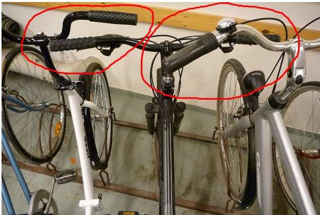
Kuvassa näkyvät molemmat keskeiset pyörätelineiden ongelmat: pyöräpaikat on sijoitettu liian ahtaasti, eikä teline tue pyörää kunnolla (jolloin etuvanteet ovat vaarassa vääntyä).
