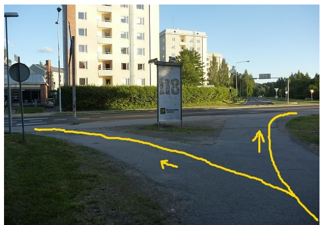
Tällainen suuntaisliittymä on monesti oivallinen ratkaisu, jolla vältetään jyrkät 90-asteiset käännökset. Kuva on suunnitellulta laatukäytävältä Keskussairaalantieltä.
