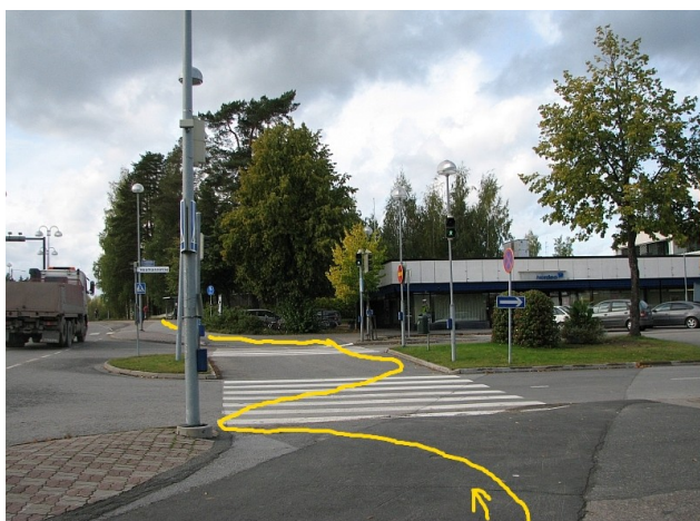
Mutkittelua liikennevalokatkaisimien perässä Vaajakoskentien suunnitellulla laatukäytävällä.
