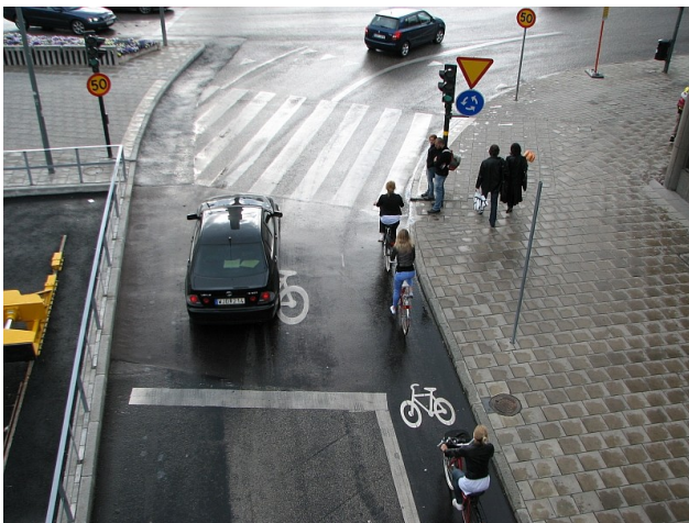
Pyöräkaista ja -tasku Tukholmassa. Myös Helsingissä on rakennettu ensimmäiset pyörätaskut.
