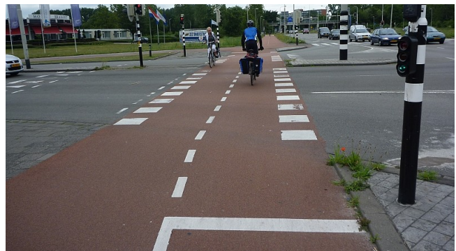
Risteyks Hollannissa: väylä on täysin suora ja tasainen. Jalkakäytävä on eroteltuna vasemmalla.
