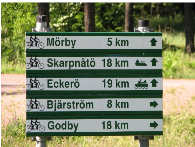
Suosittelava laatukäytävien viitoituksen taso. Kyltit ovat riittävän isoja, riittävän alhaalla ja kohtisuoraan kulkijan edessä.
