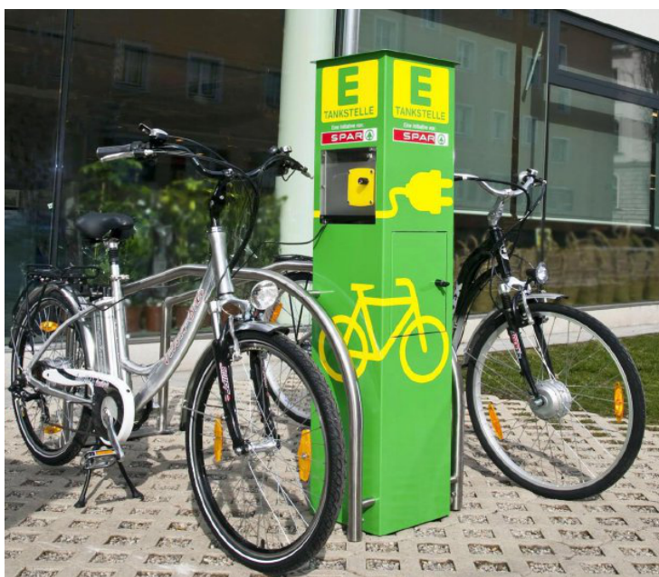
Kuva 46: Wienin uusia ratkaisuita. Aurinkopaneeleilla (tolpan päässä) toimiva sähköpyörien latausasema.
